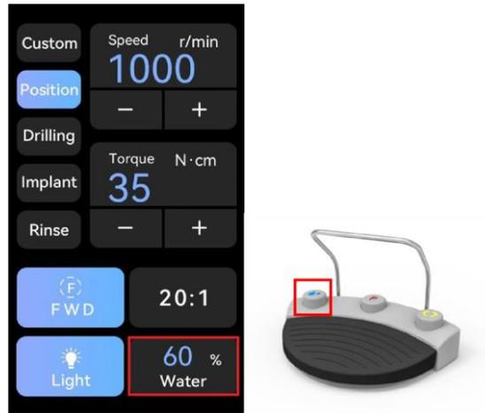
Fig. 11 Ajuste de la cantidad de agua
