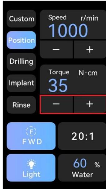
Fig. 10 Ajuste del límite superior del par
