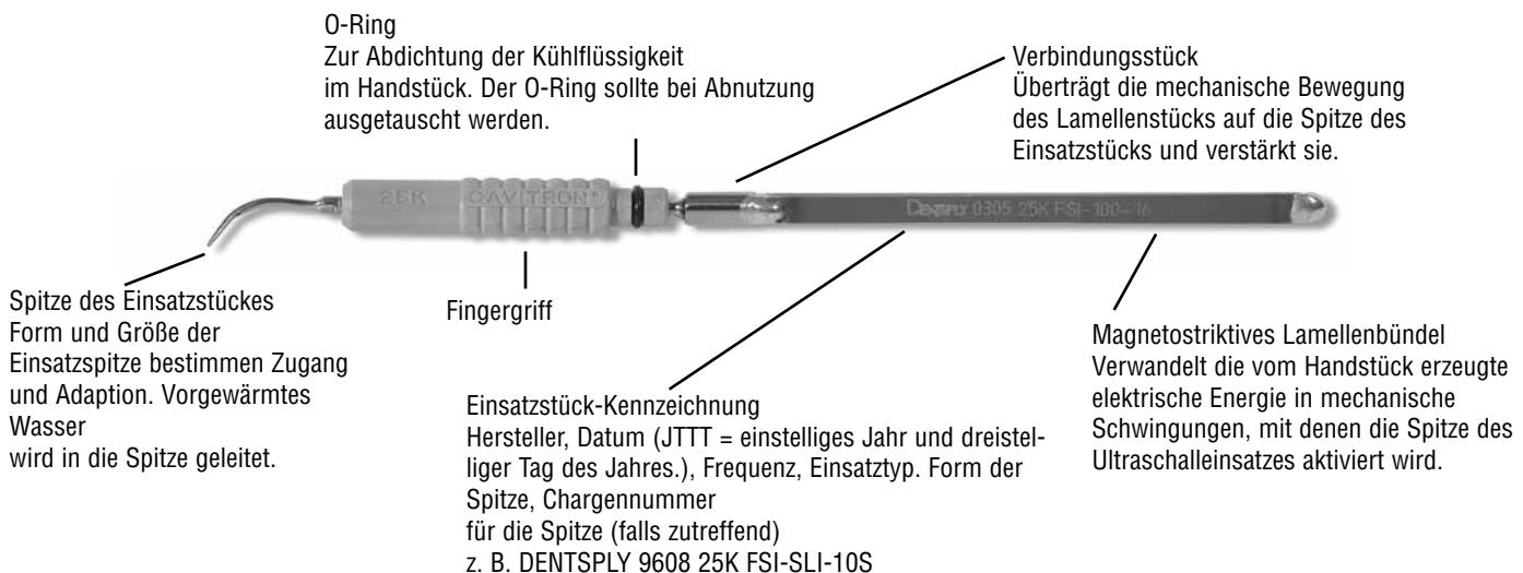
Das Handstück in aufrechter Position halten. Den Fußschalter aktivieren, um möglicherweise im Innern des Handstücks eingeschlossene Luftblasen mit Wasser zu vertreiben. Der Gummi-O-Ring des Einsatzstücks ist vor dem Aufstecken auf das Handstück mit Wasser zu beneten. Das Einsatzstück mit einer Drehbewegung unter leichtem Druck vollständig einsetzen. NICHT FORCIEREN!
