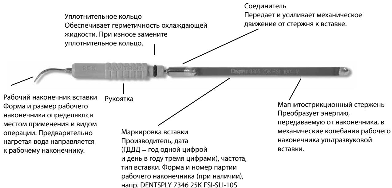
Держите наконечник вертикально. Нажмите на педаль управления до появления воды, чтобы выпустить воздух, который мог остаться в наконечнике. Перед установкой уплотнительного кольца в наконечник следует увлажнить кольцо водой, обеспечив смазку. Установите вставку на место до упора мягким нажимом с поворотом. ЗАПРЕЩАЕТСЯ ПРИЛАГАТЬ ЧРЕЗМЕРНЫЕ УСИЛИЯ.
