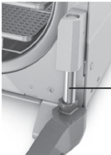
Superficie aparente del "Cerrojo de la Palanca" para lubricación.
