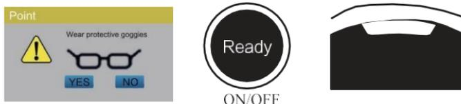
Figura 20 Diagrama esquemático del aviso de uso de anteojos, estado Listo e indicador verde
