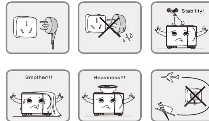
1. Enchufe la alimentación en un enchufe eléctrico de voltaje correcto (de acuerdo con la placa de identificación). No utilice enchufes eléctricos que no sean del voltaje correcto; de lo contrario, podría provocar un incendio o una descarga eléctrica.
